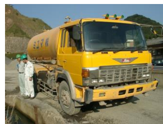
散水車による粉じん 防止対策
